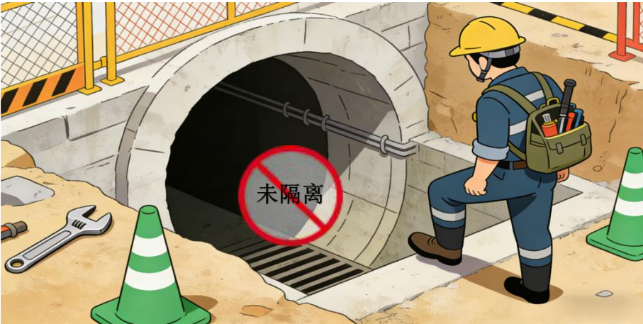
7.有限空间出入口未采用上锁、隔离栏、防护网或其他物理隔离措施或隔离措施固定不牢或承载力不足；作业结束后未恢复出入口防护隔离措施，未落实工完场清。
