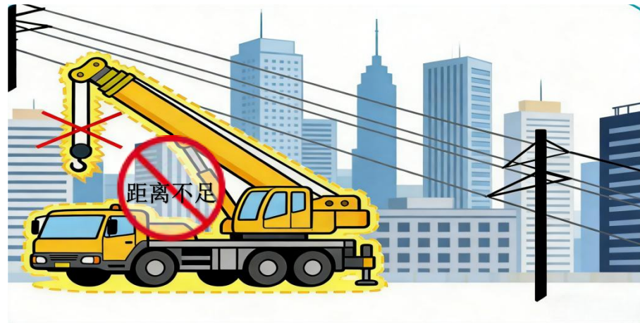
8.在建工程脚手架、机械设备、场内机动车道与外围架空线路之间的安全距离不符合规范要求且未采取防护措施。
