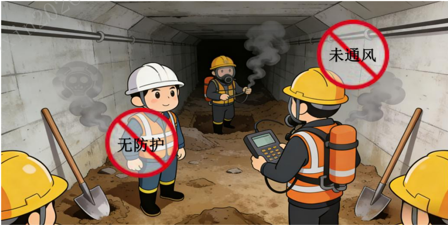
6.有限空间作业现场未配备必要的气体检测、机械通风、呼吸防护、通讯及应急救援设施设备，气体检测设备未每年进行检定。
