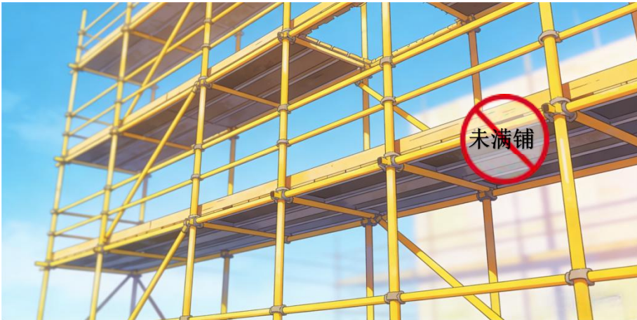
4.脚手架上脚手板未满铺，存在高坠及物体打击风险。
