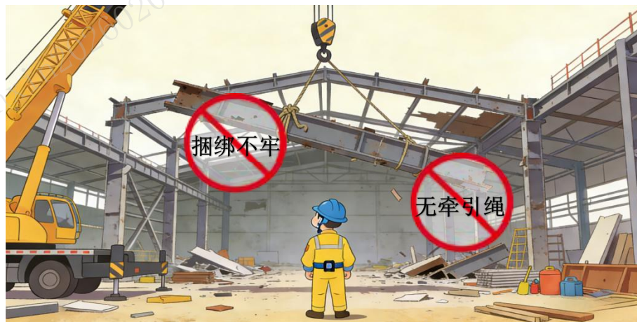
6.当拆除屋架等大型构件时，未采用吊索具将构件锁定牢固，且未待起重机械吊稳后就进行拆除作业。吊运过程中，未采用辅助措施（如牵引绳）使被吊物保持稳定状态。
