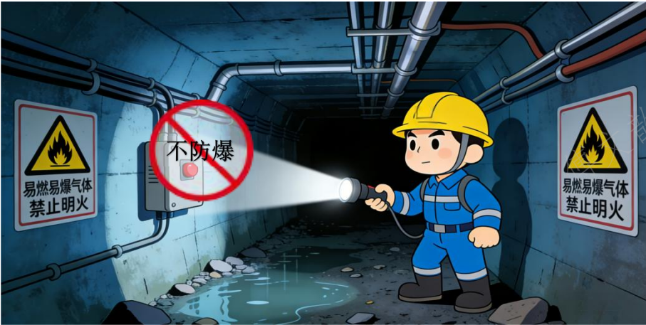
5.有限空间作业未使用安全电压，存在爆炸风险，未配备防爆型电气设备。
